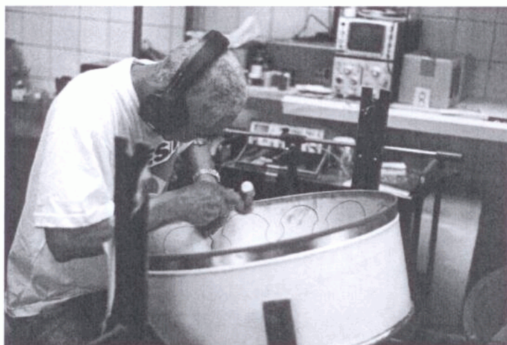
Tommy Crichlow baut ein Ping aus einer PANArtrohform
